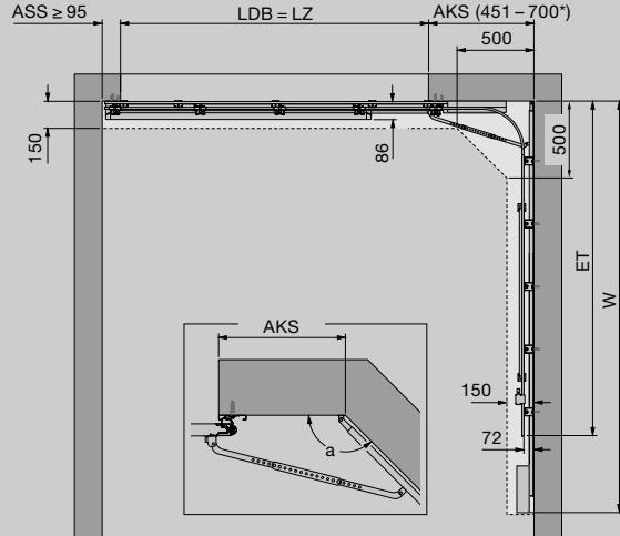
Kování ES (jednoduchá kolejnice, montáž pohonu na strop A)
